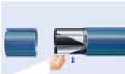
Verwijder daarna het aluminium over een lengte van de insteekdiepte van de mof. (gebruik een stukje van de geschilde mantel als hulpmiddel). Zie ook tabel op blz. 15.
